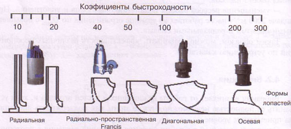
Рис. 4.9. Коэффициенты быстроходности для различных форм лопастей рабочих колес
