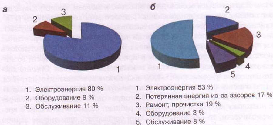
Рис. 2.3. Диаграммы составляющих суммы затрат за весь срок службы насосов, перекачивающим чистую (а) и сточные (б) воды
