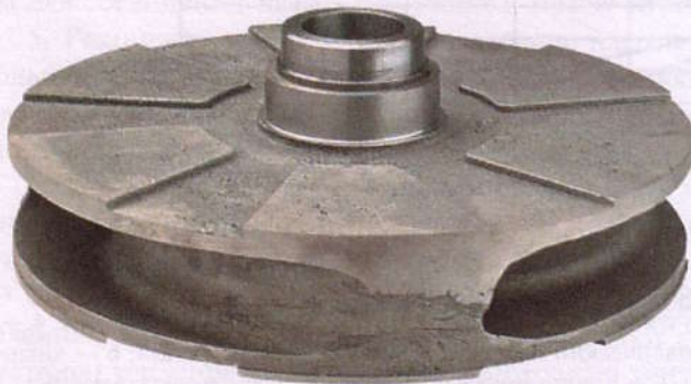
Рис. 4.13. Радиальные ребра на задней стороне рабочего колеса для снижения осевого усилия
