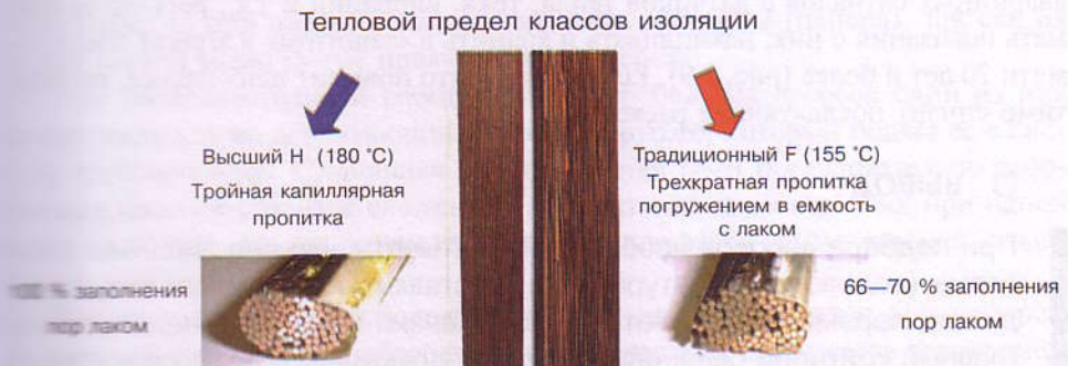
Рис. 2.8. Характеристика классов изоляции электродвигателей N и F. «Каждые 10 °C теплового запаса почти удваивают жизнь электродвигателя», — говорят специалисты
