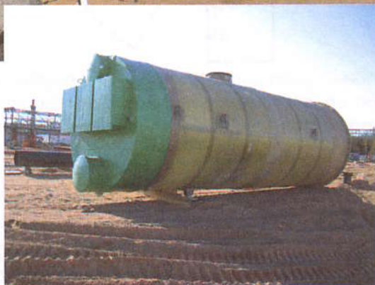
Рис. 5.70. Монтаж стеклопластиковой станции весьма прост. Стеклопластиковый корпус насосной станции «Эколайн» (внизу)
