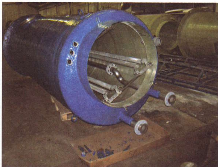
Рис. 5.62. Комплектная насосная станция из стеклопластика производства ООО «Фертил», Санкт-Петербург
