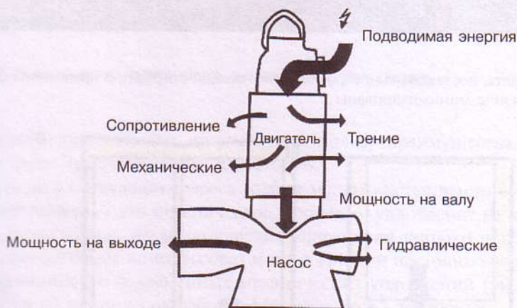
Рис. 1.10. Составляющие потерь мощности электронасосного агрегата
