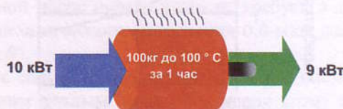
Рис. 1.6. Водяное охлаждение электродвигателя в погружных насосах позволяет экономить электроэнергию: 10% потерь в электродвигателе мощностью всего 10 кВт — это 1 кВт, производящий нагрев 100 кг металла до 100 °С за 1 час
