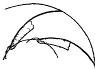
Рис 2.43. Кавитационные камеры в рабочем колесе
