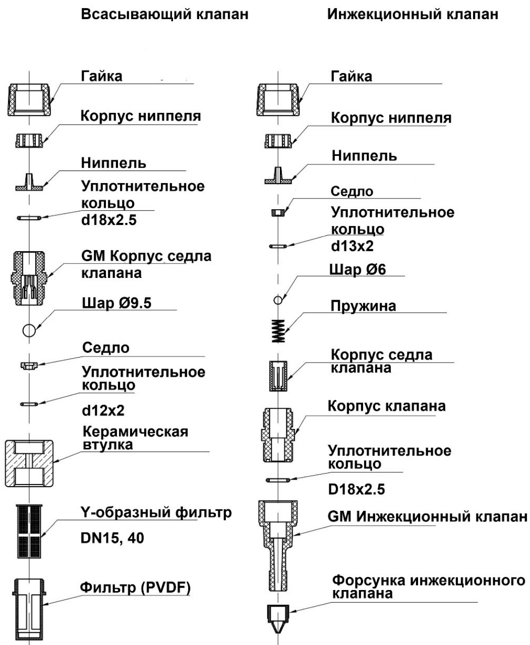
Рисунок 18 – Компоненты всасывающего и инжекционного клапанов
