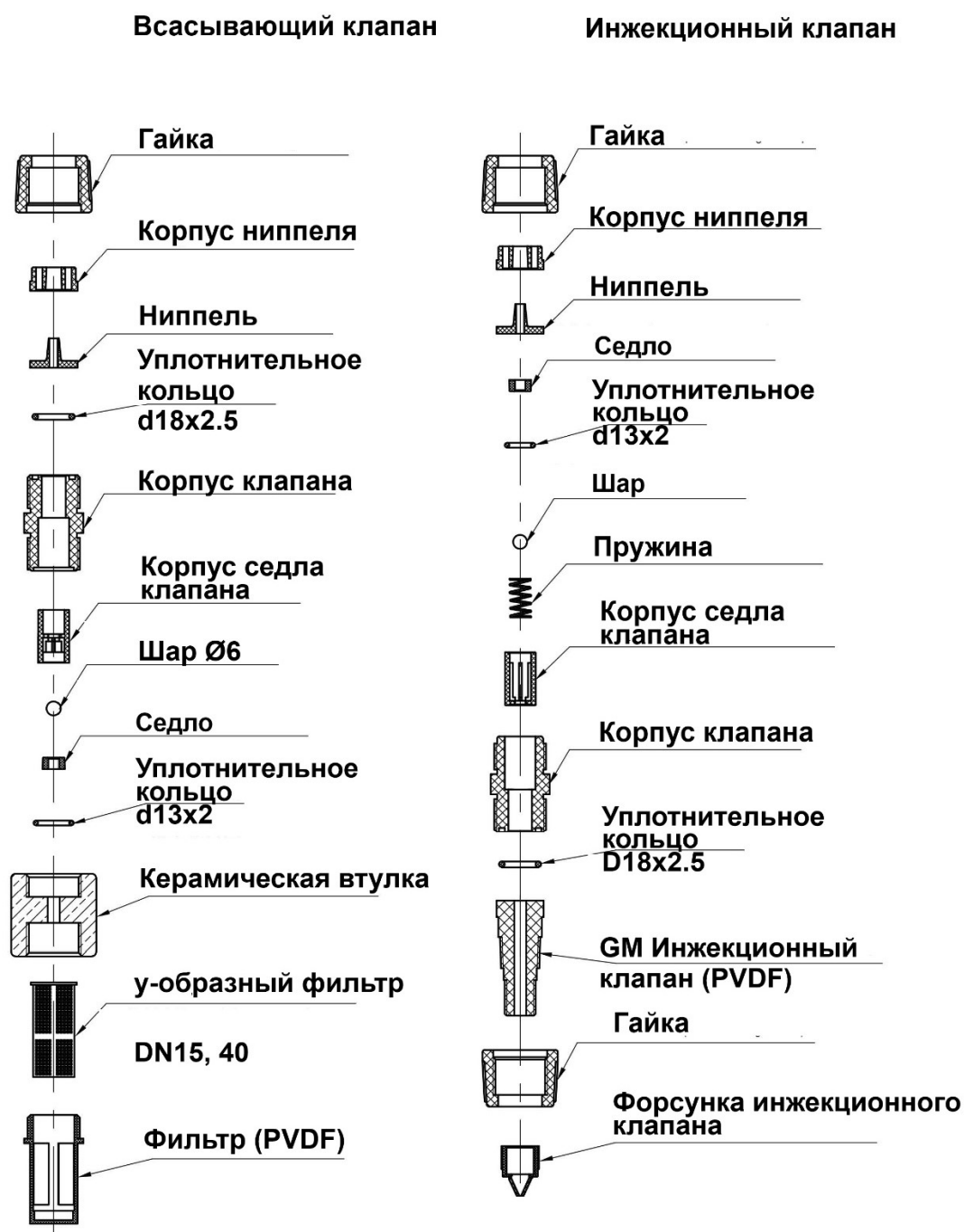
Рисунок 19 - Компоненты всасывающего и инжекционного клапанов
